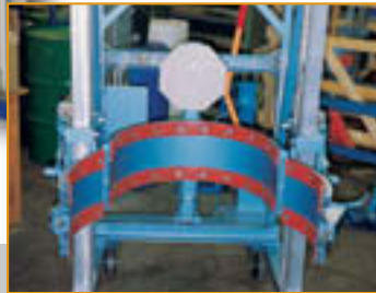
Sicherheitsaufnahme für kleine Gebinde mit Einspannung
