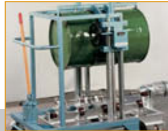
Absetzen eines Fasses auf einen Rotationsmischer
