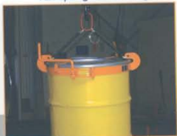
Drum clamp unit as crane attachment Griffe de serrage servant d'agres de grue
