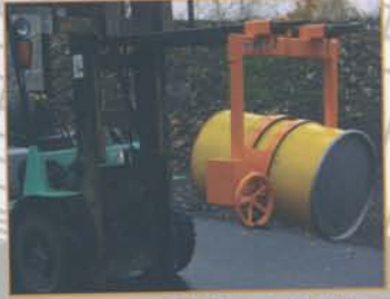
Fork lift truck with tilt beam Traverse de basculement avec chariot élévateur à fourche
