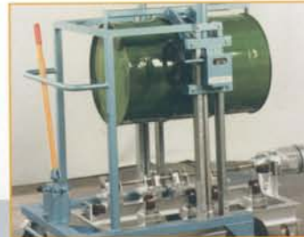
Lowering a drum onto a rotary mixer Pose d'un fût sur un mélangeur rotatif
